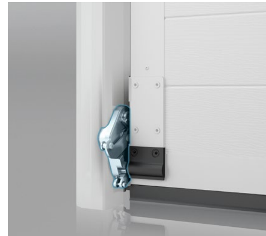
Seilbruchsicherung. Verhindert den Absturz des Torblattes bei Seilbruch.
