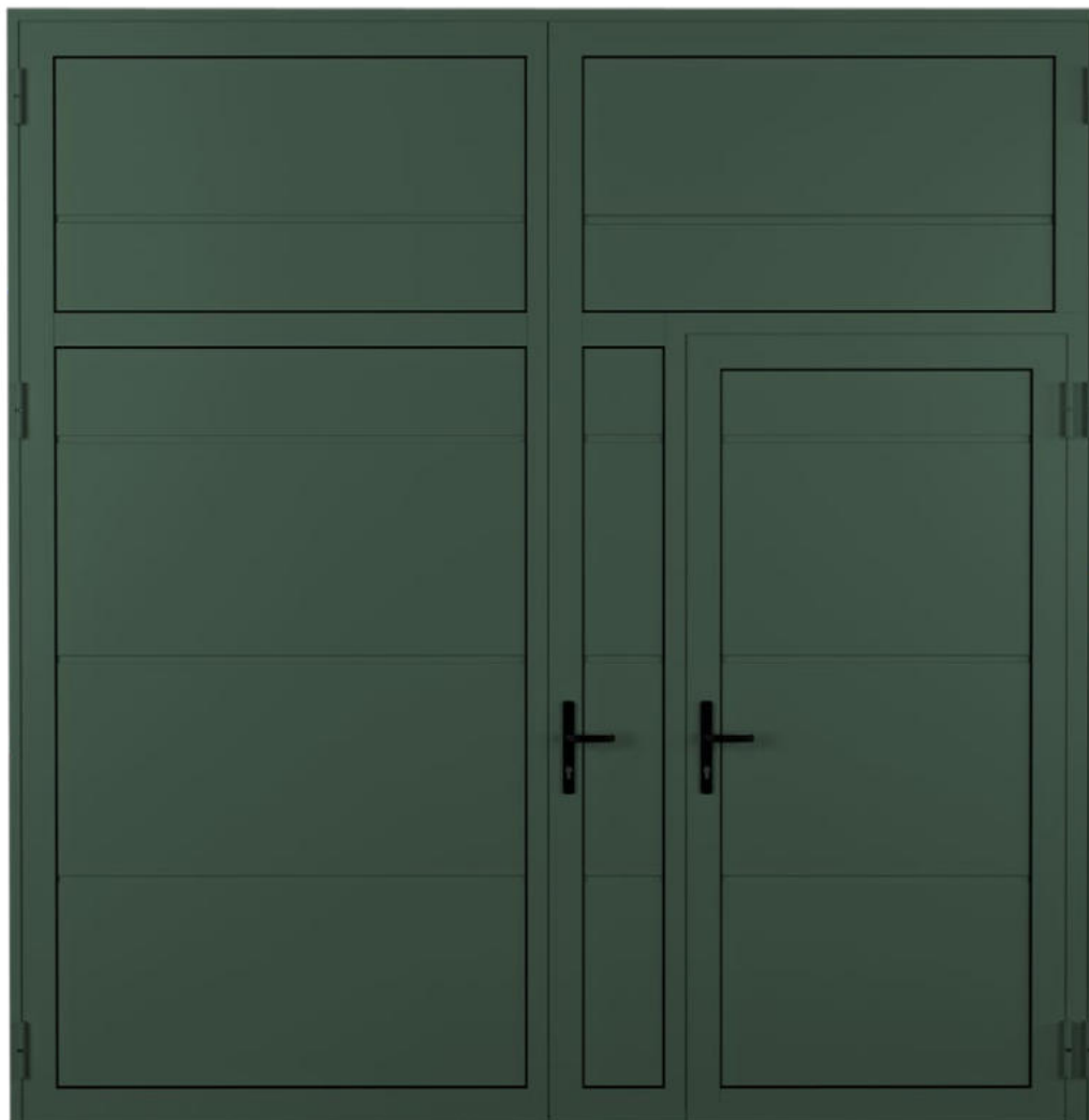
Zweiflügeliges Drehflügeltor PRESTO 50 mit Schlupftür – Tore mit einer Höhe H_o \geq 3000 mm oder mit einer Schlupftür haben einen zusätzlichen horizontalen Verstärkungsstab auf einer Höhe von 2087 mm
